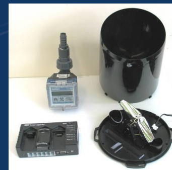
Équipement de prises de données pour les eaux de lessivage (débitmètre, auget à bascule, Smartflex et beaucoup de bricolage!)
